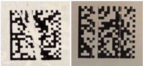
Нарушение целостности КМ*
